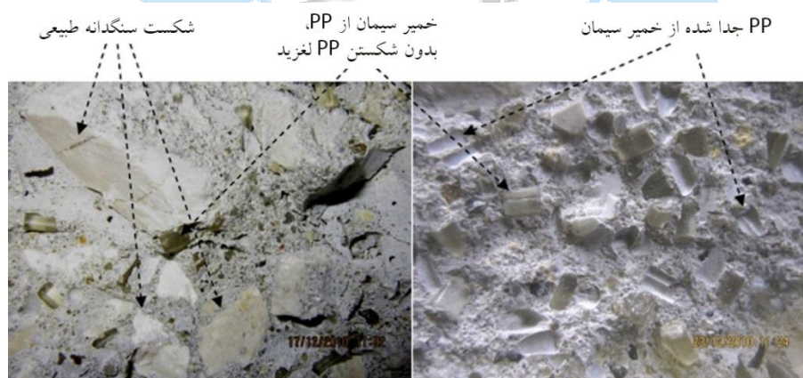
شکل ۴: نمونه‌های بتنی حاوی PP پس از شکست در آزمون مقاومت شکافتگی کششی. [۳۷]
