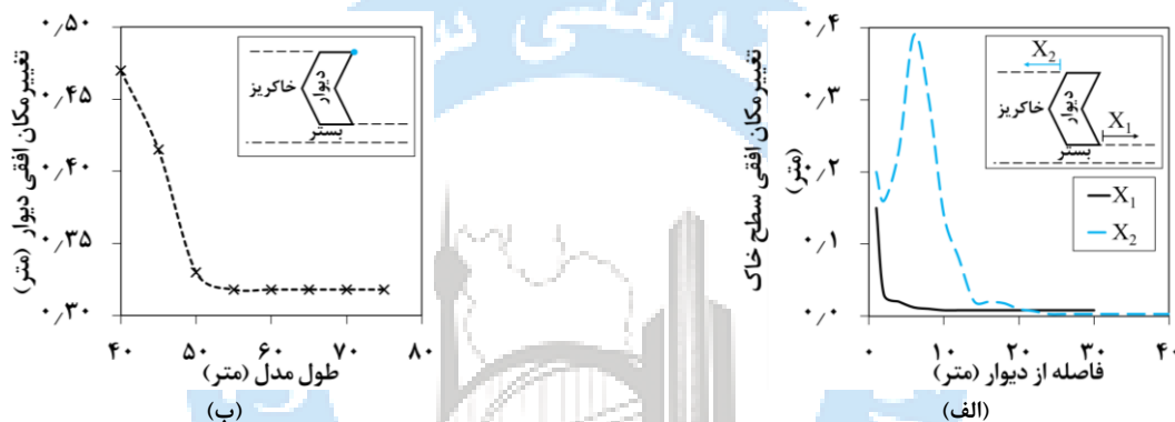
شکل ۲: نتایج تحلیل حساسیت‌سنجی برای تعیین طول بهینه مدل عددی: (الف) تغییرات تغییرمکان افقی سطح فوقانی خاک در جلو و پشت دیوار، و (ب) تغییرات تغییرمکان افقی بالای دیوار نسبت به طول مدل.
