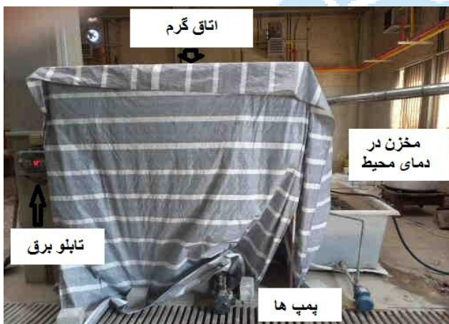
شکل ۳: تجهیزات شبیه‌سازی سیکل تر و خشک در دمای محیط و حرارت.
