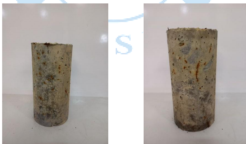
شکل ۱۵: تصویر زنگ‌زدگی الیاف فولادی تحت سیکل‌های تر و خشک.
