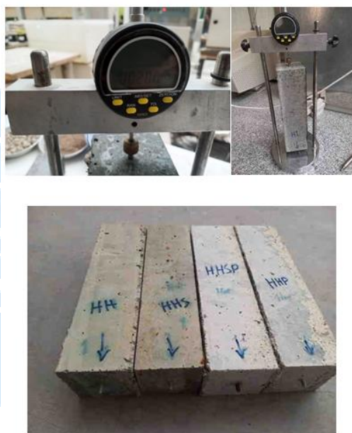
شکل ۴: تصویری از دستگاه جمع شدگی و تعدادی از نمونه‌ها.
