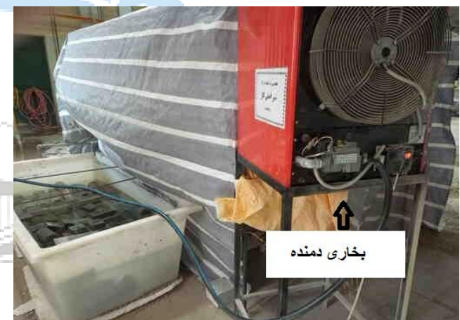
شکل ۳: تجهیزات شبیه‌سازی سیکل تر و خشک در دمای محیط و حرارت.
