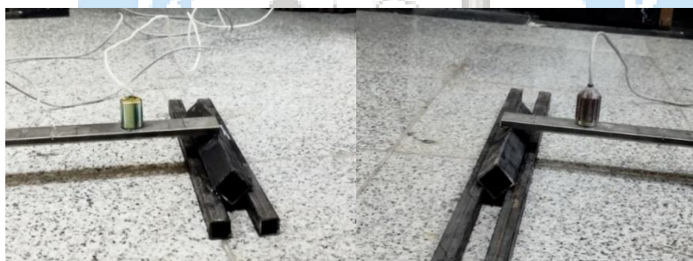
شکل ۶: نحوه نصب سنسورهای شتاب سنج.
