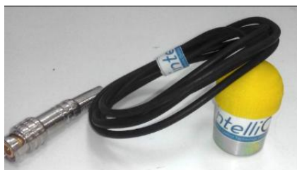
شکل ۴: سنسور تک محوره ولتاژی ژئوفون.
