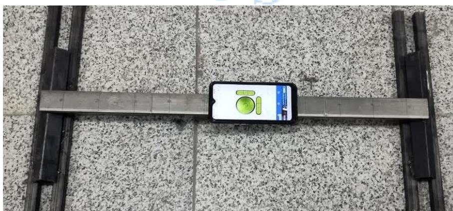
شکل ۲: تیر فولادی دو سر ساده در آزمایشگاه.
