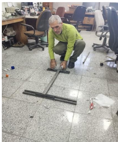
شکل ۷: مونتاژ تیر فولادی دوسر ساده.
