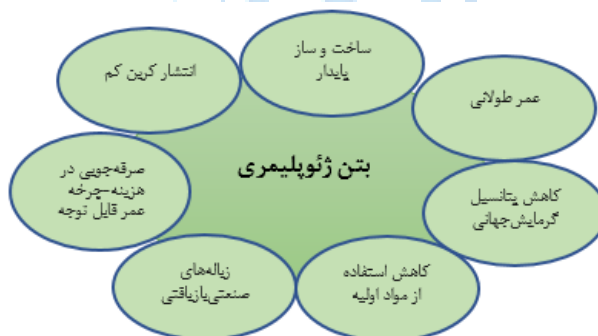
شکل ۳: استفاده از بتن ژئوپلیمری در ساخت و ساز [۱۹].
