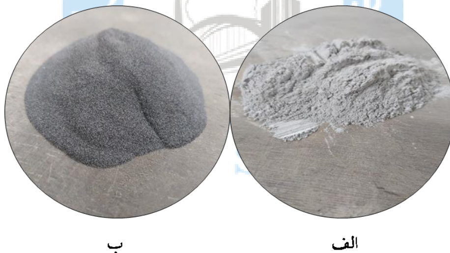
شکل ۳: انواع سرباره آلومینیوم (الف) سرباره آلومینیوم سفید. (ب) سرباره آلومینیوم سیاه.
