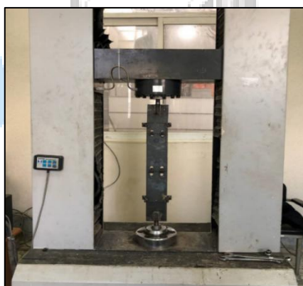
شکل ۴: ستاپ آزمایشگاهی میراگر در دستگاه universal
