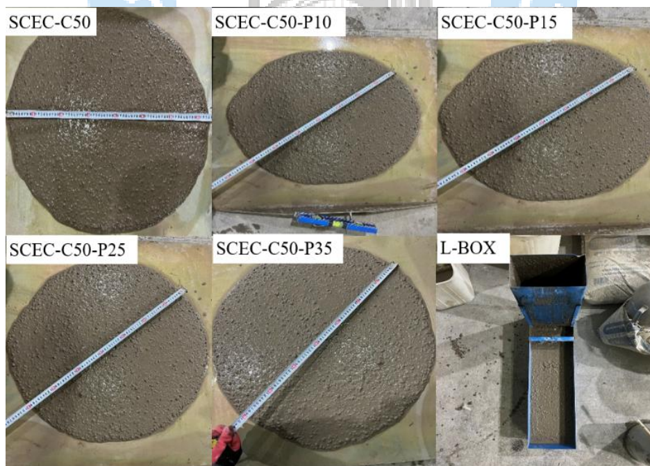
شکل ۴: جریان اسلامپ انواع طرح اختلاط بتن خودمتراکم خاکی
