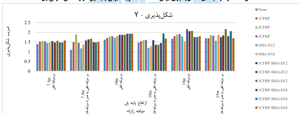
شکل ۱۵: نمودار میله‌ای شکل پذیری برای ۱۲ حالت تقویت برای پایه پل در راستای عرضی پل.
