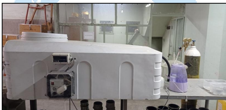
شکل ۴: طرح کلی آزمایش کربناتاسیون تسریع شده.
