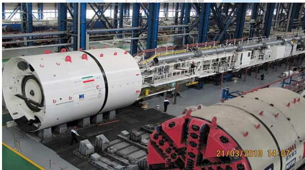
شکل ۶- دستگاه‌های EPB برای حفر تونل‌های قطار شهری اهواز در کارخانه سازنده (Arabzade B., 1386)
