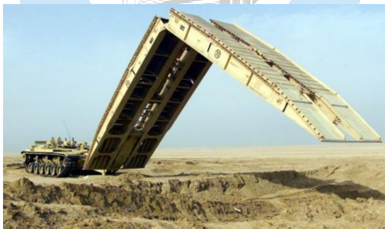
شکل ۱: خودرو زرهی پل‌گذار مجهز به پل دو تکه قیچی از جنس آلیاژ آلومینیوم و قابلیت عبور نیروی زرهی از موانع تا فاصله ۶۰ فوت [۱]
