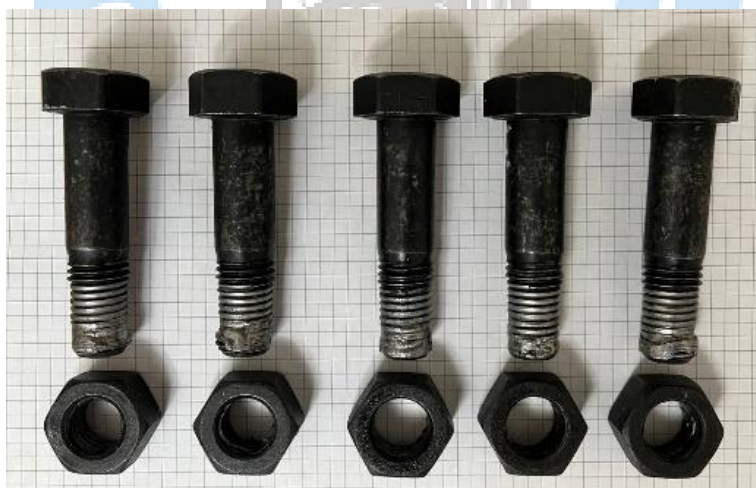
شکل ۷: مکانیزم گسیختگی نمونه‌های آزمایش در آزمون استحکام کششی ساختار پیچ و مهره
