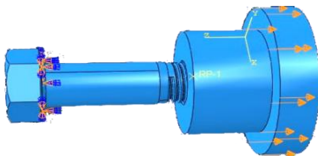
شکل ۱۵: شرایط تکیه‌گاهی و اعمال جابجایی پیچ آزمایش‌شده با ابزار ایزو
