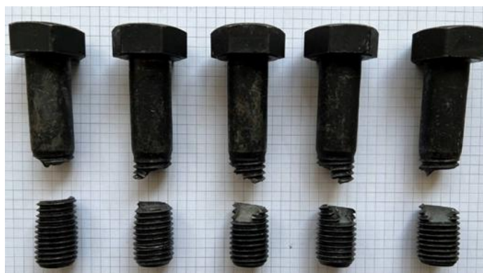
شکل ۴: مکانیزم گسیختگی پنج نمونه پیچ M20 با رده مقاومتی ۱۰/۹، در آزمون کشش ایزو
