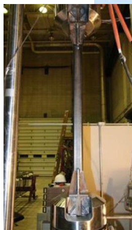
شکل ۷: نحوه آزمایش و اندازه بادبند مورد بررسی در مطالعه آزمایشگاهی پژوهش شن و همکاران [۳۷].
