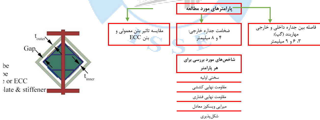
شکل ۹: چارت مورد استفاده برای مطالعه پارامتریک و هندسه مقطع مهابند مقاوم در برابر کماتش.
