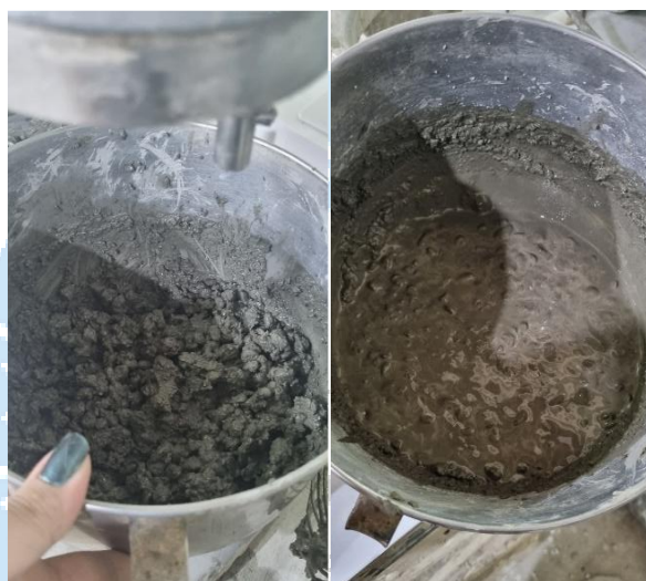
شکل ۳: ساخت مخلوط بتن در مخلوط‌کن.
