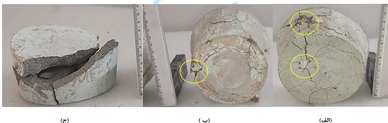
شکل ۱۰: الف) جدا شدگی موضعی و انتشار ترک در بتن معمولی ب) جدا شدگی موضعی و انتشار ترک در بتن مقاومت بالا ج) قطعه قطعه شدگی بتن فوق توانمند
