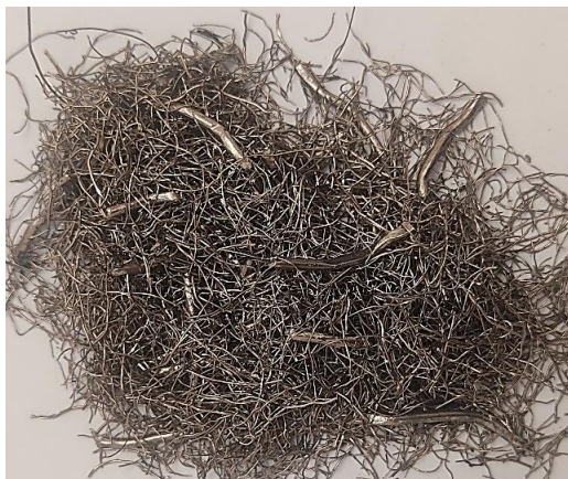
شکل ۲: الیاف فولادی بازیافتی
