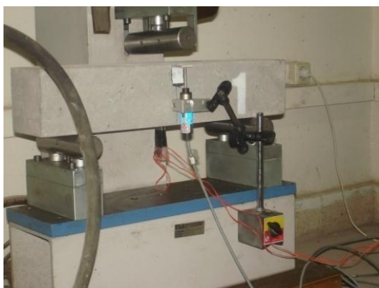
شکل ۹ - آزمایش تیر خمشی شکاف‌دار تحت بار سه نقطه‌ای
