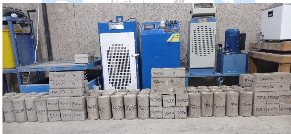
شکل ۳: نمونه های بتن خاکی خودمتراکم.
