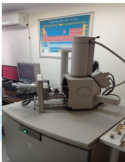
شکل ۶: دستگاه مورد استفاده برای میکروسکوپ الکترونی روبشی (FESEM)
