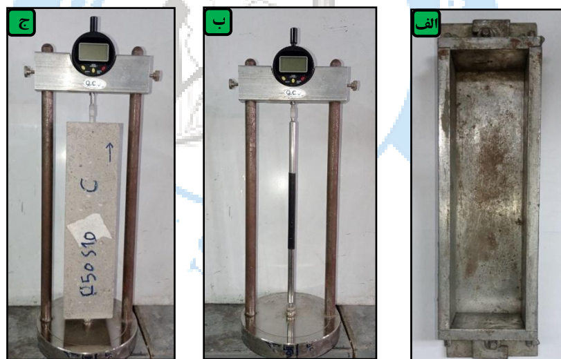
شکل ۵: (الف) قالب انقباض. (ب) تنظیم مقایسه کننده طول با میله مرجع. (ج) اندازه‌گیری طول نمونه.
