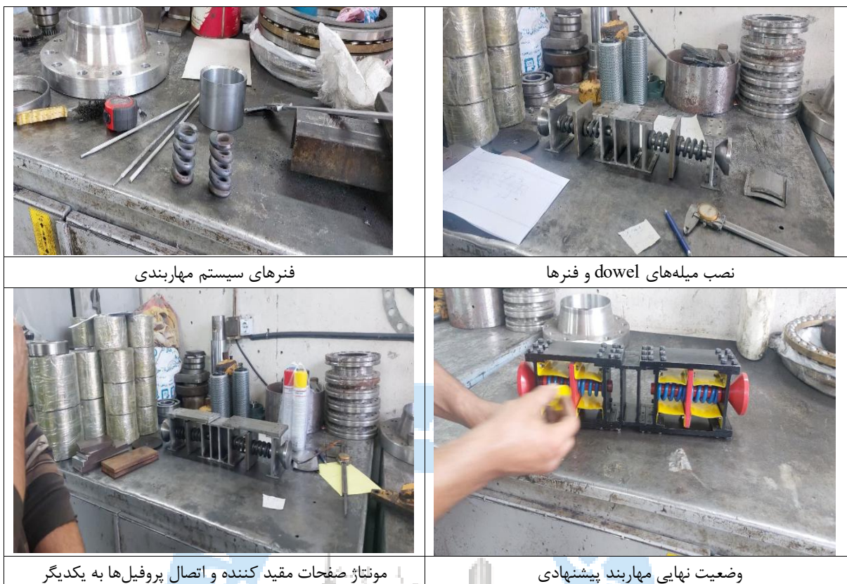
شکل ۳: مراحل مونتاژ نمونه مهاربند پیشنهادی.
