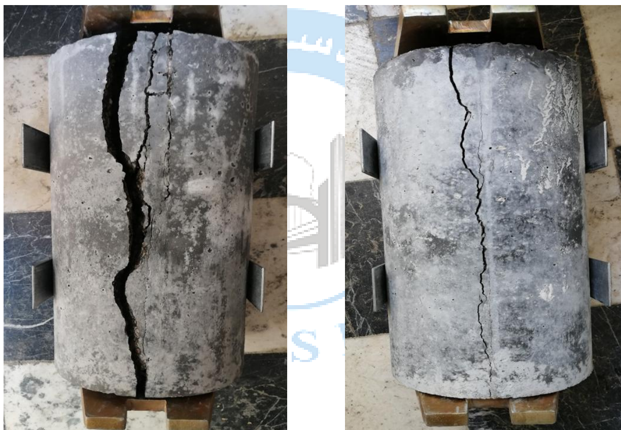
شکل 11: گسیختگی نمونه LW-Ref بعد از آزمایش مقاومت کششی
