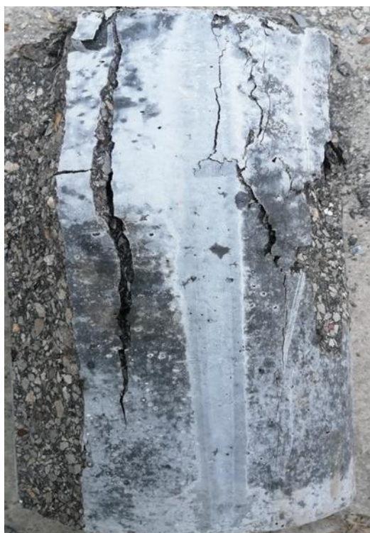
شکل 9: شکست نمونه حاوی 1/75٪ الیاف بازالت (BF1.75%) بعد از اعمال بار فشاری
