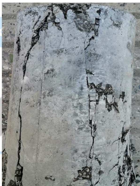
شکل 6: شکست نمونه بتن با وزن نرمال (NW-Ref) بعد از اعمال بار فشاری
