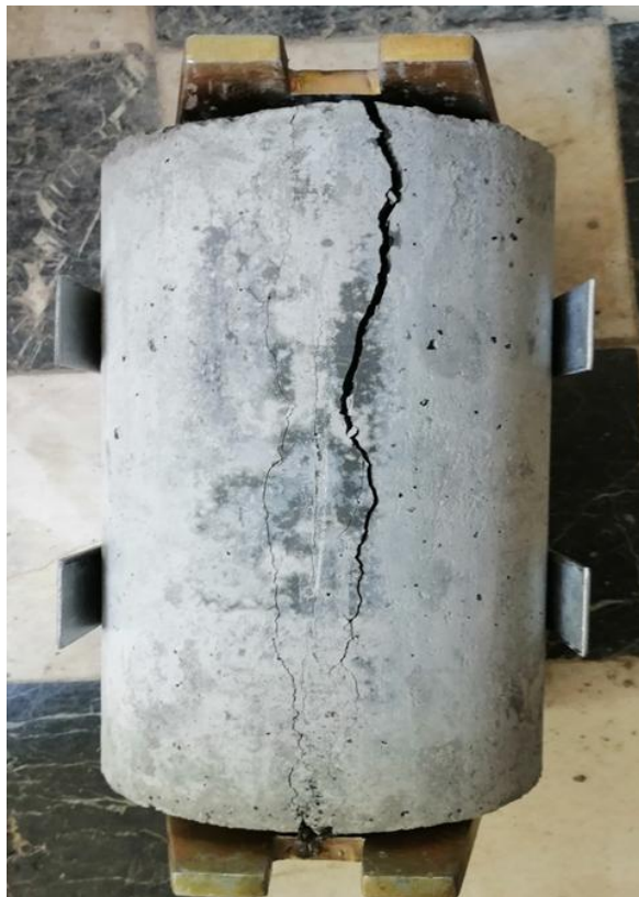
شکل 13: گسیختگی نمونه LW-B1.75% بعد از آزمایش مقاومت کششی
