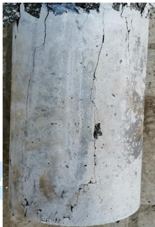
شکل 8: شکست نمونه بتن سبک حاوی 1٪ الیاف پلیمری (PF1%) بعد از اعمال بار فشاری
