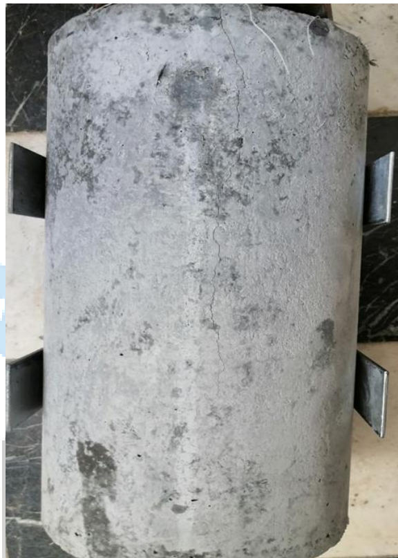
شکل 12: گسیختگی نمونه LW-P1% بعد از آزمایش مقاومت کششی
