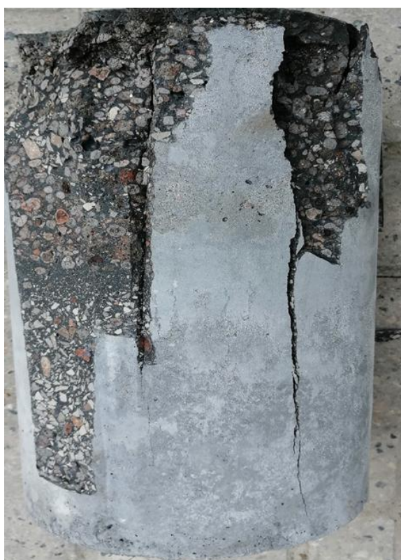
شکل 7: شکست نمونه بتن سبک فاقد الیاف (LW-C) بعد از اعمال بار فشاری
