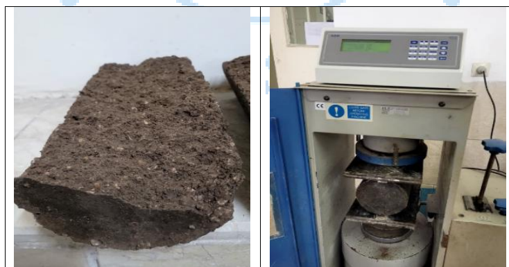
شکل 19: آزمایش شکست آزمون‌های استوانه‌ای با دستگاه جک بتن شکن و آزمون شکسته شده بتن خودتراکم با و بدون زنگ و براده آهن
