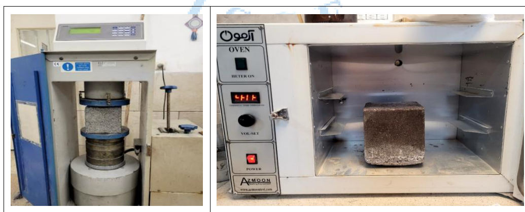
شکل 15: آزمون مکعبی در فور خشک‌کننده و شکست با دستگاه مقاومت فشاری
