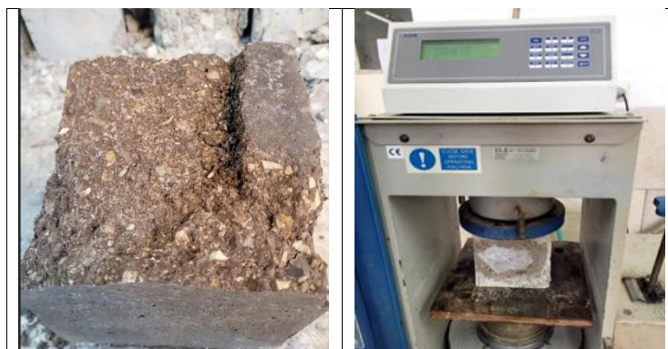
شکل 17: آزمایش شکست آزمون مکعبی با دستگاه جک بتن شکن و آزمون شکسته شده بتن خودتراکم با و بدون زنگ و براده آهن
