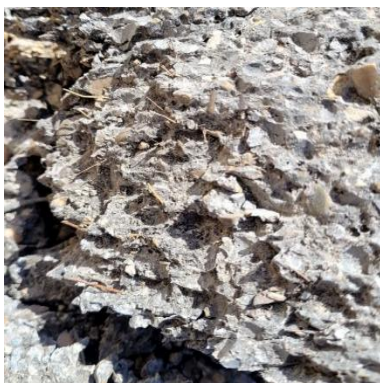
شکل 19: آزمایش شکست آزمون مکعبی با دستگاه جک بتن شکن و آزمون شکسته شده بتن خودتراکم با الیاف خرما
