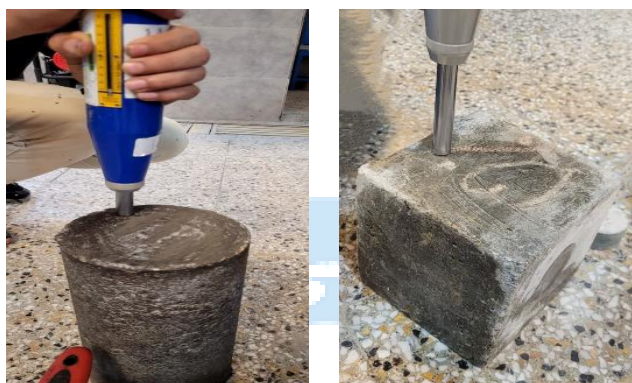
شکل 12: آزمایش چکش اشمیت بر روی آزمون‌های مکعبی و استوانه‌ای
