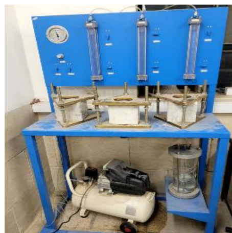
شکل 16: دستگاه نفوذپذیری بتن و نتایج آزمایش نفوذپذیری
