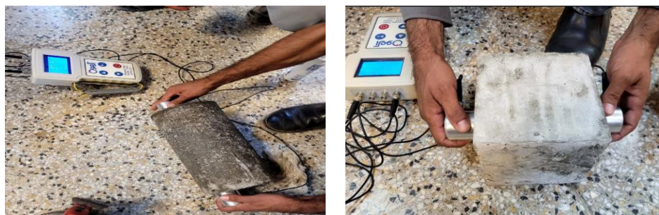
شکل 14: آزمایش سرعت پالس آلتراسونیک بر روی آزمون‌های مکعبی و استوانه‌ای
