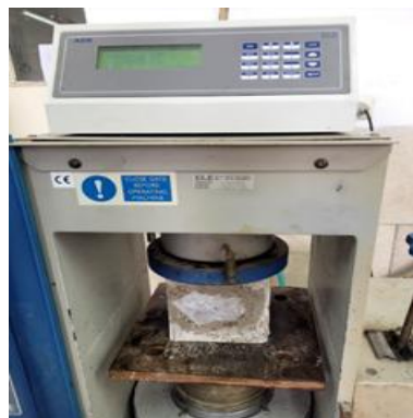
شکل 19: آزمایش شکست آزمون مکعبی با دستگاه جک بتن شکن و آزمون شکسته شده بتن خودتراکم با الیاف خرما
