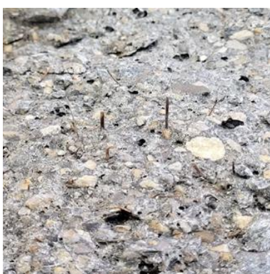
شکل 21: آزمایش شکست آزمون استوانه‌ای با دستگاه جک بتن شکن و آزمون شکسته شده بتن خودتراکم با الیاف خرما
