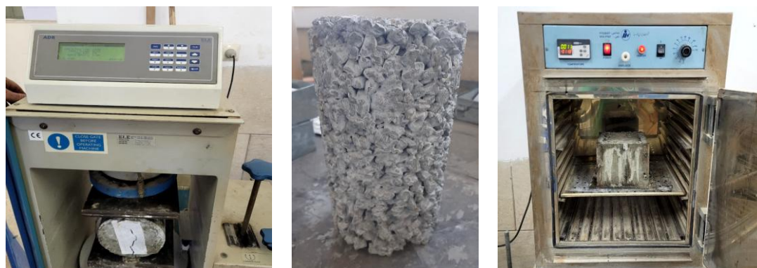
شکل 17: آزمون استوانه‌ای در فر خشک کننده و شکست با دستگاه مقاومت کششی
