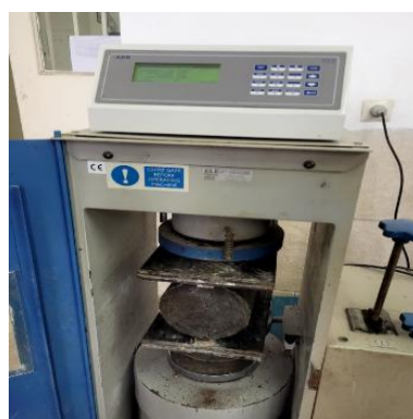
شکل 21: آزمایش شکست آزمون استوانه‌ای با دستگاه جک بتن شکن و آزمون شکسته شده بتن خودتراکم با الیاف خرما
