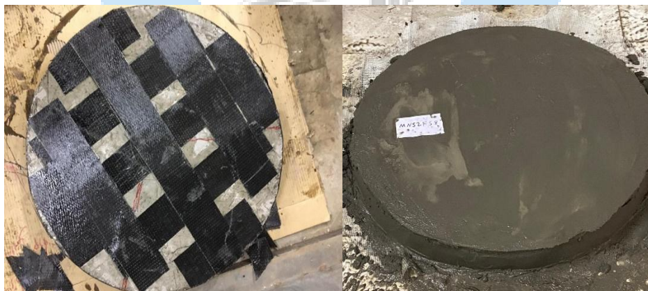
الف- با ملات ترمیمی NS2SF8 ب- با ورق کربن (CFRP) بصورت مشبک (طرح 1)
