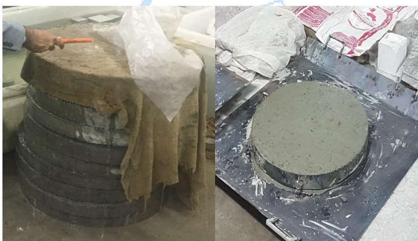
شکل ۴: ساخت نمونه‌های دال بتن الیافی دایروی شکل براساس استاندارد ASTM C1550
