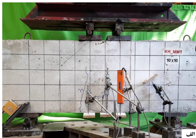
شکل 6: ستاپ آزمایش الف) قرارگیری نمونه N1H0 تحت خمش چهار نقطه، ب) چارچوب آزمایش و محل قرارگیری LVDT و کرنش سنج
