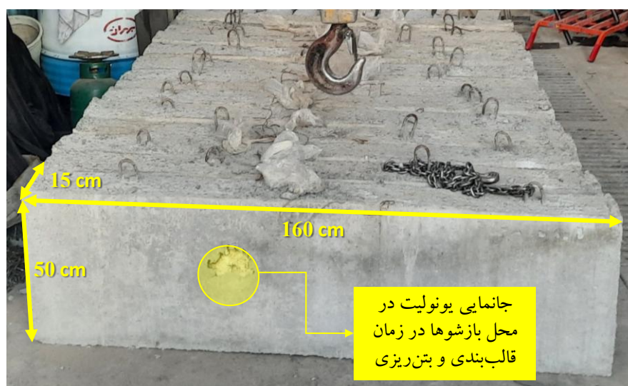
شکل 1: ابعاد هندسی نمونه‌های آزمایش
