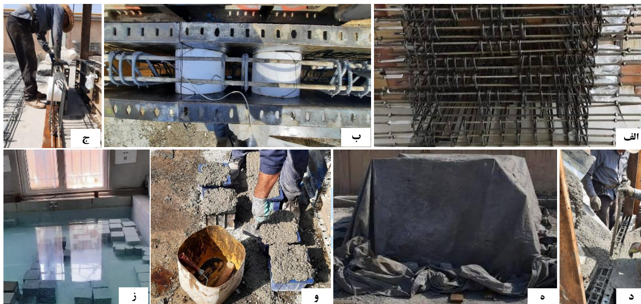
شکل 3: فرآیند ساخت نمونه‌ها (الف) آرماتوربندی نمونه‌ها، (ب) نمای از بالا از قالب‌بندی تیرها، (ج) قالب‌بندی تیرها، (د) عملیات بتن‌ریزی، (ه) قرارگیری نمونه‌ها تحت بخار، (و) نمونه‌های مکعبی، (ز) شرایط نگهداری نمونه‌های مکعبی
