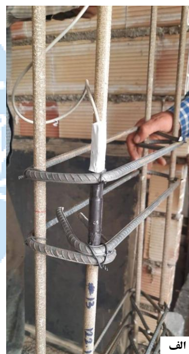
شکل 14: بررسی میلگردهای GFRP (الف) نصب کرنش‌سنج بر روی میلگردهای GFRP و عایق نمودن در برابر رطوبت، (ب) نمودار کرنش-بار در میلگردهای GFRP
