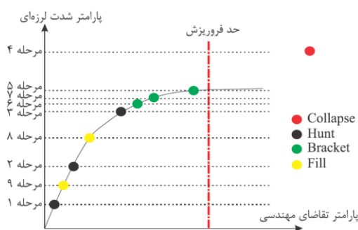
شکل ۱۱: نمودار تحلیل دینامیکی افزایشی به کمک الگوریتم Hunt & Fill [۲۲].
