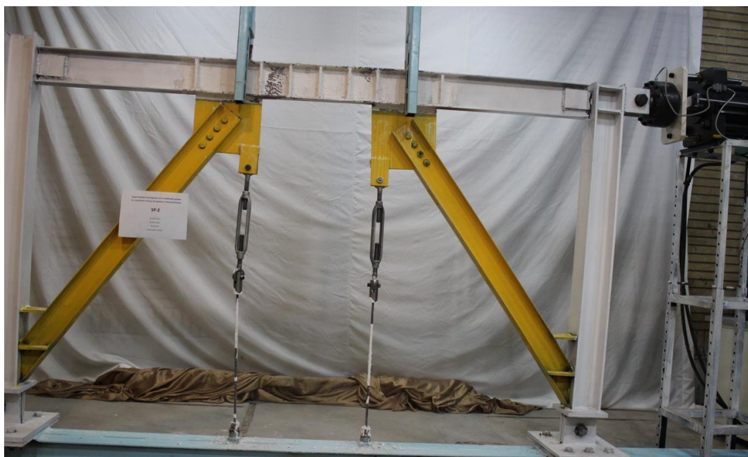
شکل ۹. تغییر شکل تیر پیوند در نمونه شماره دو (SP2) در انتهای بارگذاری
