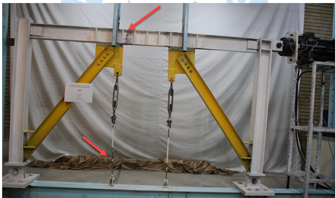
شکل ۶. جاری شدن محوری المان میلگرد در کشش و جاری شدن تیر پیوند در برش در نمونه شماره دو (SP2)
