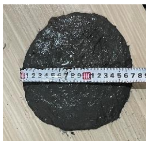
شکل ۲۲: روانی ملات پس از افزودن الیاف فولادی میکرو.
