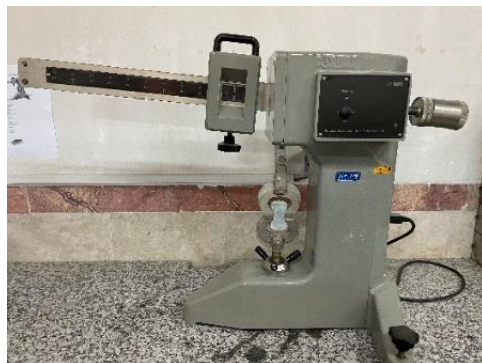
شکل ۱۴: تجهیزات و نحوه بارگذاری کشش بریکت ۸ شکل.
