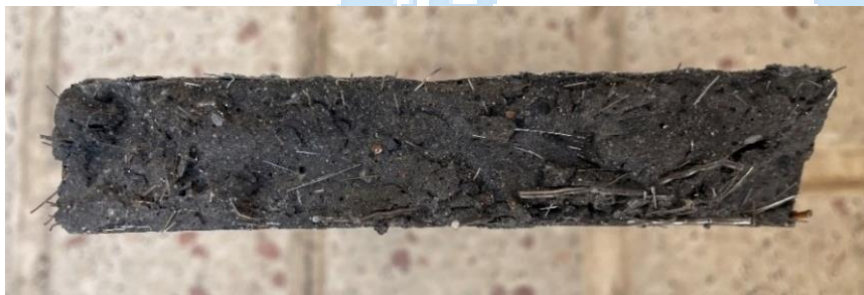
شکل ۲۱: ته‌نشینی الیاف ماکرو فولادی موجدار در مقطع عرضی ورقه SFPW1-QP-mS1.5-MSC1.
