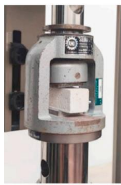
شکل ۱۱: آزمایش مقاومت فشاری بر روی نیمه‌ی نمونه خمشی [۲۰].
