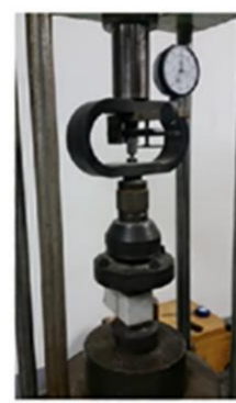
شکل ۱۰: آزمایش مقاومت فشاری بر روی نیمه‌ی نمونه خمشی [۵۲].
