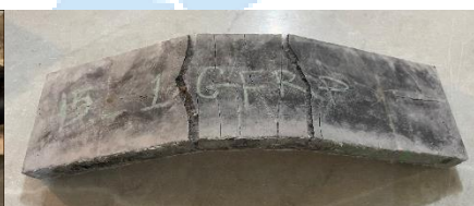
شکل ۲۵: نمونه SFPW0.54-PP2 مسلح به یک میلگرد GFRP به قطر ۶ میلی‌متر.
