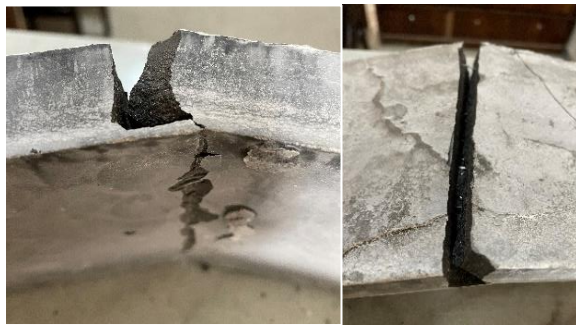
شکل ۱۸: نمای قسمت بدون الیاف در نمونه SFPW0.28-MSH1.9 به دلیل ته‌نشینی.
