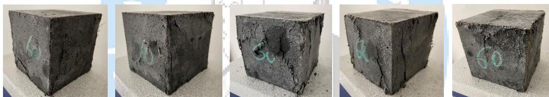
شکل ۳۸: آزمون های مکعبی نمونه SFPW1.1-CC-QP-mS1.8-PVA0.5 پس از آزمایش مقاومت فشاری.
