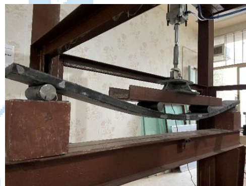
شکل ۳۱: تغییر شکل نمونه SFPW1.1-CC-QP-mS1.8-PVA0.5.
