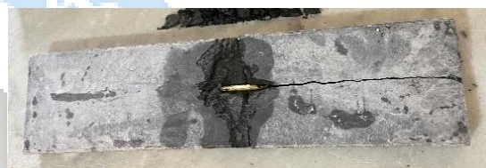
شکل ۲۴: دونیم‌شدن نمونه SFPW0.54-SP27-F0
