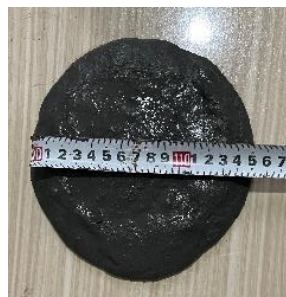
شکل ۲۳: روانی ملات قبل از افزودن الیاف فولادی میکرو.
