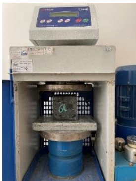
شکل ۱۳: آزمایش مقاومت فشاری نمونه مکعبی با ابعاد ۱۰۰ میلی‌متر.
