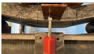
شکل ۲۵: نمونه SFPW0.54-PP2 مسلح به یک میلگرد GFRP به قطر ۶ میلی‌متر.
