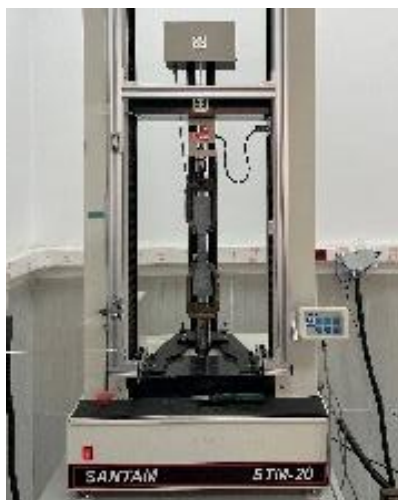
شکل ۱۵: تجهیزات آزمایش کشش نمونه دمبلی شکل.
