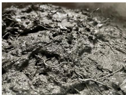
شکل ۱۹: مخلوط تازه SFPW0.28-MSH1.9 بدون ته‌نشینی الیاف.
