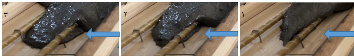
شکل ۳۳: نفوذ ملات کامپوزیت سیمانی با الیاف میکرو به بخش زیرین میلگردهای GFRP بدون استفاده از لرزاننده.
