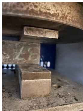
شکل ۱۴: آزمایش مقاومت فشاری نمونه مکعبی با ابعاد ۴۰ میلی‌متر.
