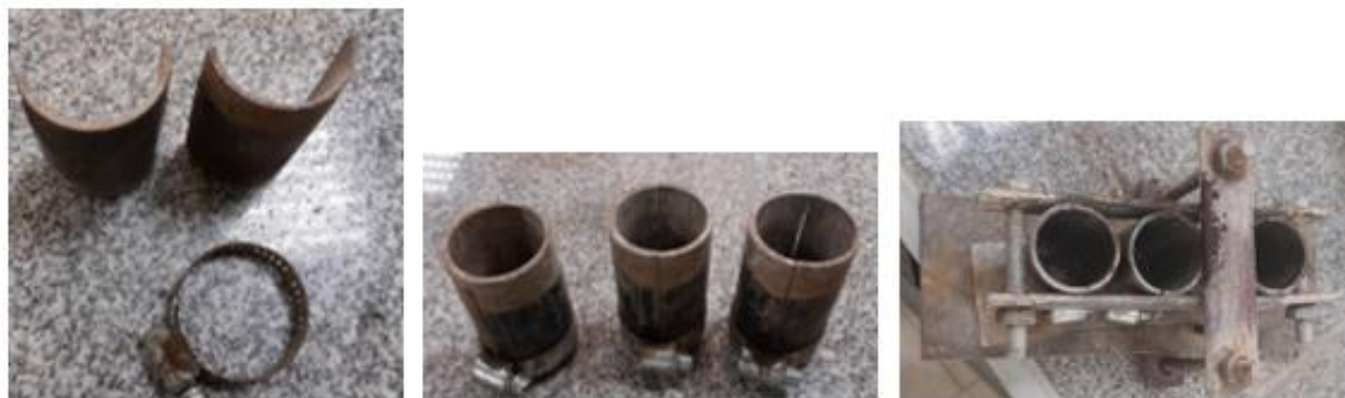
شکل ۲: قالب ساخت نمونه‌ها- الف- قالب سرهم شده - ب- سه قالب به صورت جدا از هم- ج- قالب باز شده
