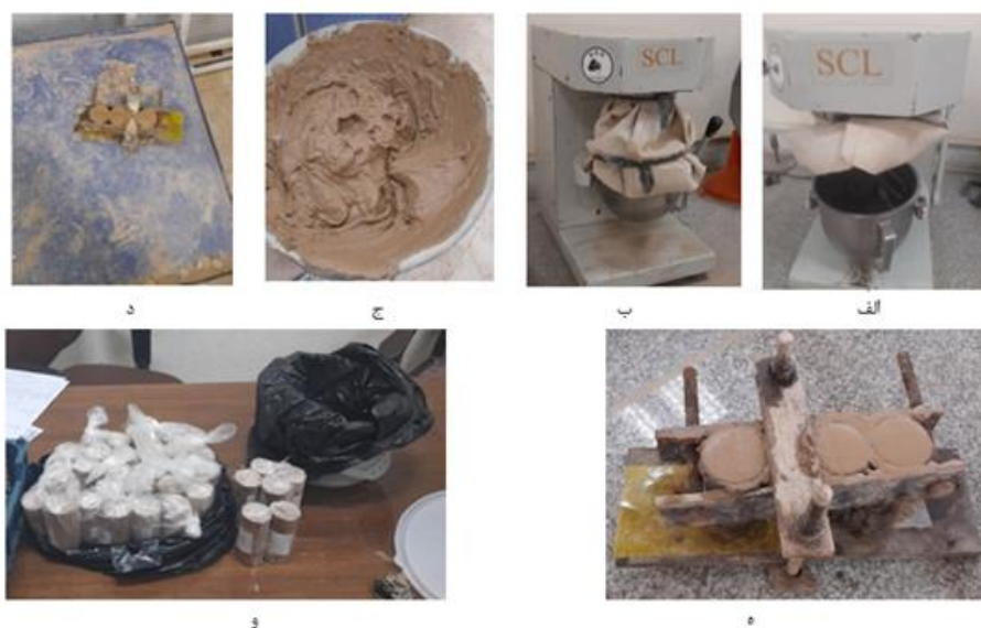
شکل ۳: مراحل آماده سازی نمونه-الف-میکسر-ب-میکسر با درپوش-ج-خاک روان پس از اضافه نمودن آب به مخلوط خاک-د-قالب نمونه روی میز ویبره-ه-صاف کردن روی نمونه ها پس از ویبره شدن-و-نمونه های سلفون پیچیده شده و نگهداری شده در اتاق
