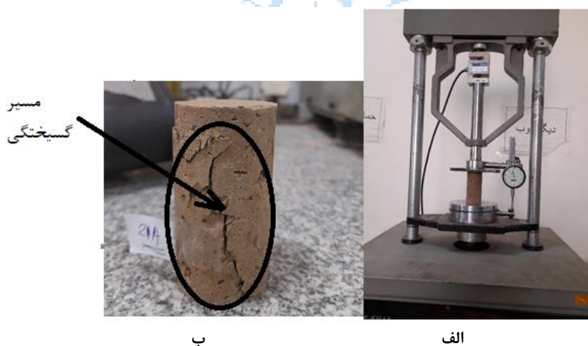
شکل ۴: الف- نمونه در دستگاه تک محوری-ب- نمونه پس از گسیخته شدن
