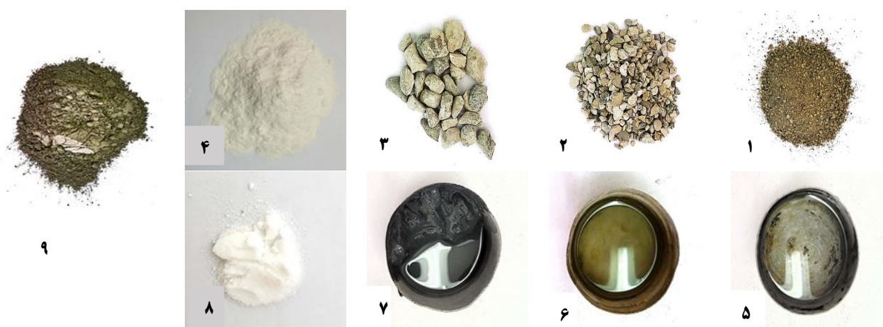
شکل ۲: مصالح مورد مصرف در طرح اختلاط بتن خودتراکم (۱-ماسه، ۲-شن نخودی، ۳-شن بادامی، ۴-پودر سنگ، ۵-آب، ۶-فوق روان کننده، ۷-ژل میکرو سیلیس، ۸-افزودنی اصلاح کننده ویسکوزیته، ۹-سیمان)
