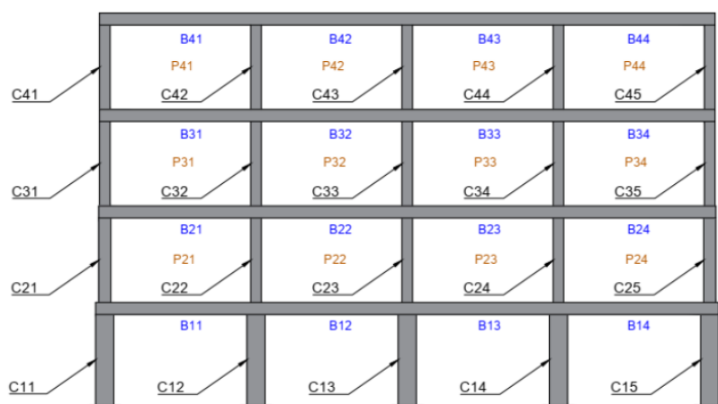
شکل ۳: پیکربندی کلی قاب‌های مورد مطالعه و نامگذاری اجزای مختلف تیر، ستون و پانل میانقاب
