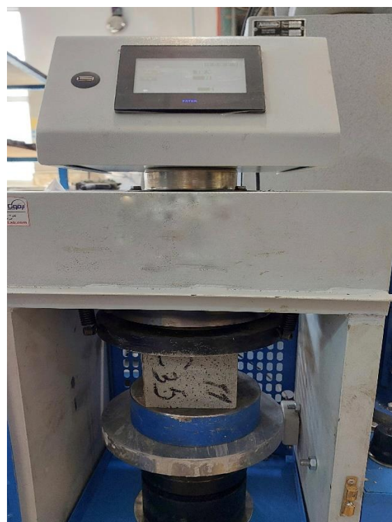
شکل ۴: نمونه مکعبی تحت آزمایش مقاومت فشاری
