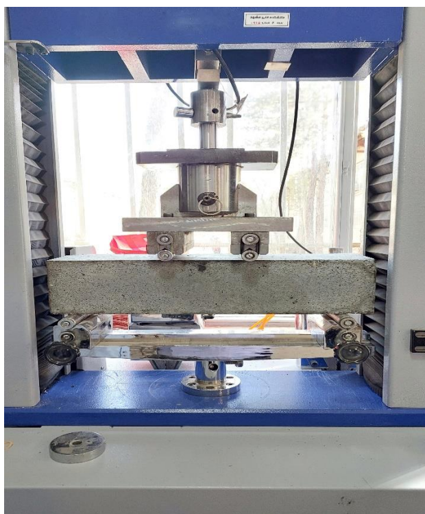
شکل ۵: نمونه منشوری تحت آزمایش خمشی سه نقطه‌ای
