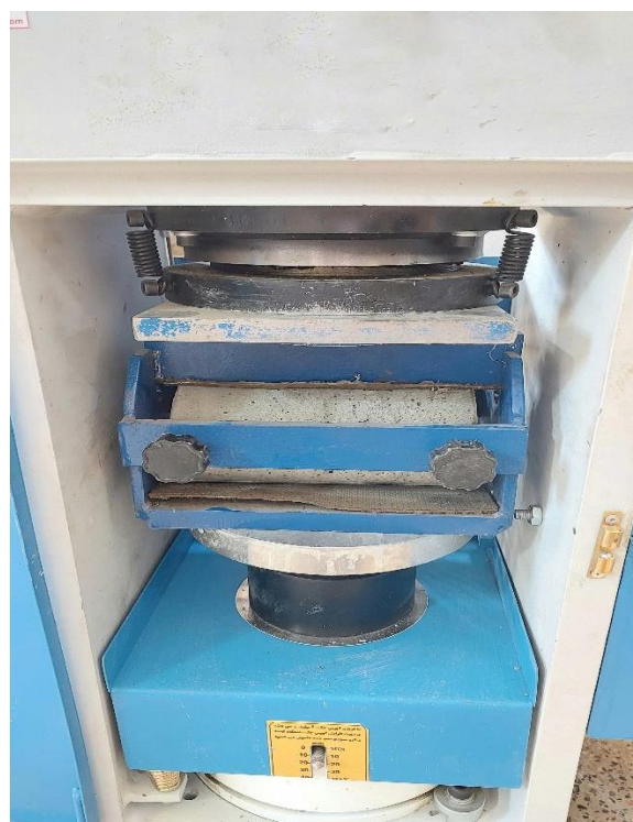
شکل ۶: نمونه استوانه‌ای تحت آزمایش مقاومت کششی
