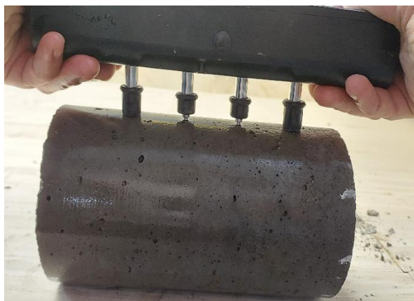
شکل ۹: نمونه استوانه‌ای تحت آزمایش مقاومت الکتریکی
