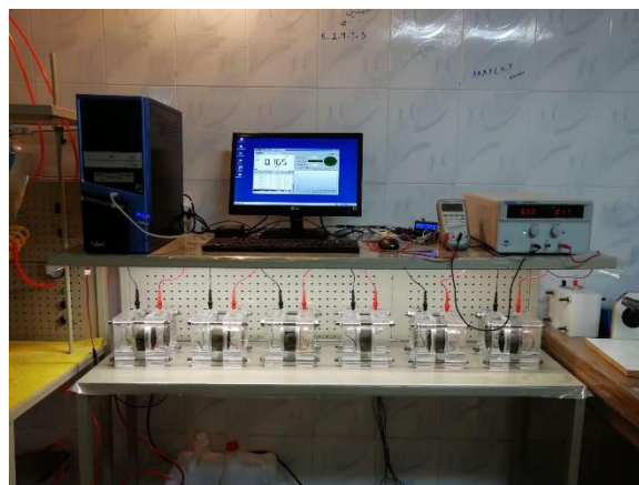
شکل ۸: نمونه تحت آزمایش RCPT
