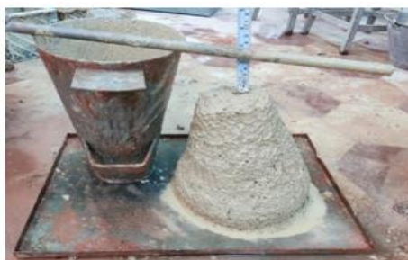
شکل ۴ آزمایش اسلامپ بر روی برخی از نمونه‌های تحقیق
