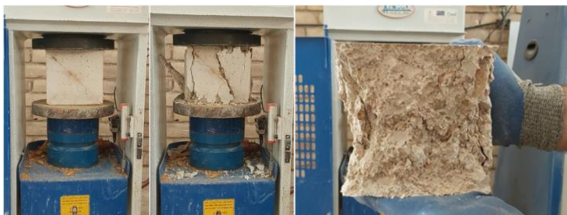
شکل ۶ تصویری از روند انجام آزمایش مقاومت فشاری بتن
