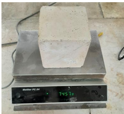
شکل ۱۱ توزین نمونه مکعبی خشک شده پس از جذب آب در بتن
