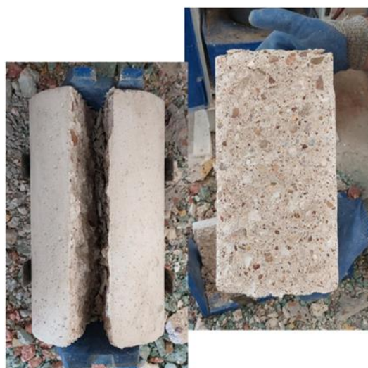
شکل ۸ آزمایش مقاومت کششی و شکست نمونه استوانه‌ای پس از آزمایش تعیین مقاومت کششی
