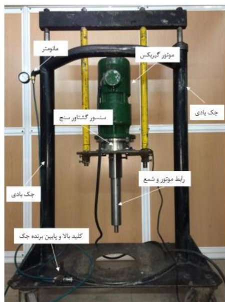
شکل ۵: دستگاه به منظور اجرای شمع در تحقیق.
