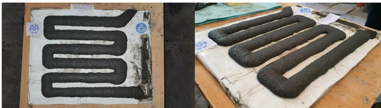
شکل ۳: ساخت نمونه بتنی چاپ پذیر
