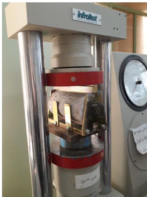
شکل ۶- دستگاه و روش انجام آزمایش مقاومت کششی دو نیم شدن
