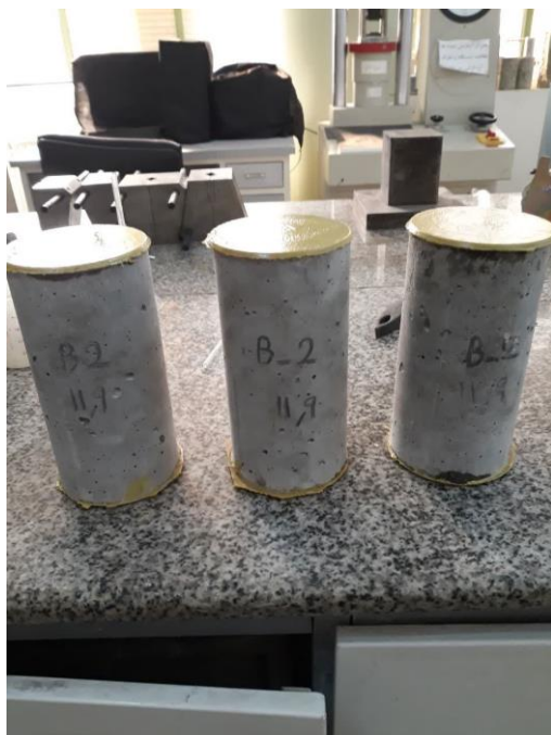
شکل ۵- مراحل آماده‌سازی و نمونه‌های آماده شده برای آزمایش مقاومت فشاری.
