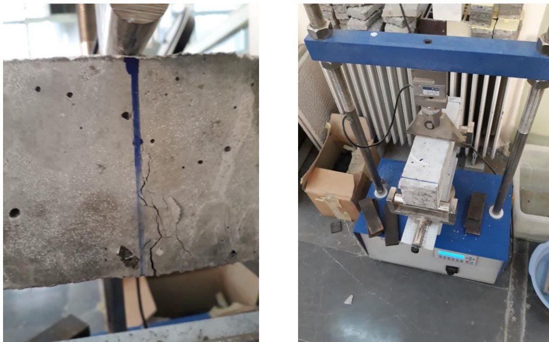
شکل ۷- دستگاه و روش انجام آزمایش مقاومت خمشی سه نقطه‌ای
