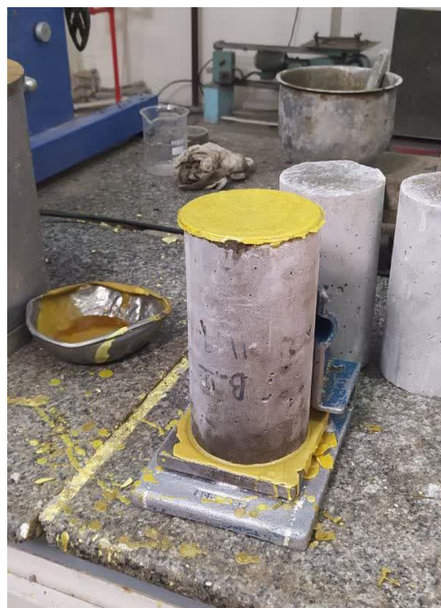
شکل ۵- مراحل آماده‌سازی و نمونه‌های آماده شده برای آزمایش مقاومت فشاری.
