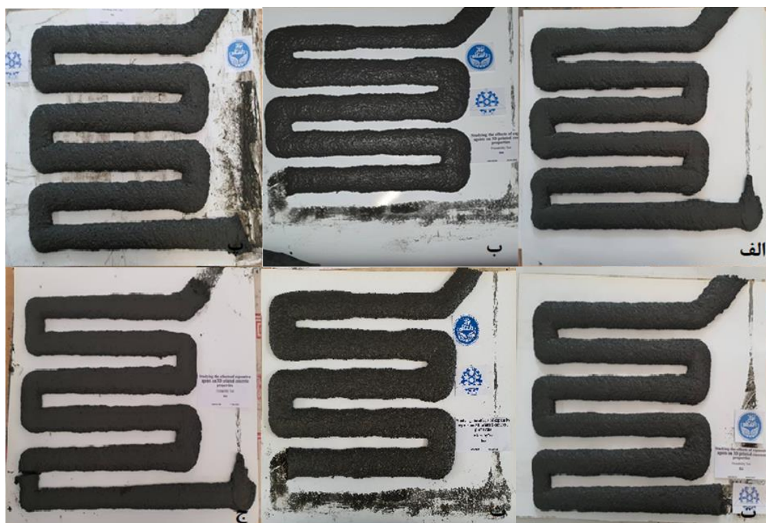
شکل ۱۶: نمونه‌های چاپ شده برای بررسی کیفی معیارهای چاپ پذیری الف) طرح CON ب) طرح A پ) طرح B ت) طرح C ث) طرح D ج) طرح E.
