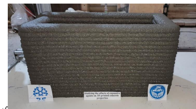
شکل ۱۵: نمونه چاپ شده (طرح D) برای بررسی کیفی معیارهای ساخت‌پذیری.
