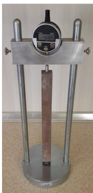
شکل ۱۷- دستگاه اندازه گیری جمع شدگی خشک ملات و نتایج اندازه گیری درصد تغییر طول نمونه‌ها به طول اولیه
