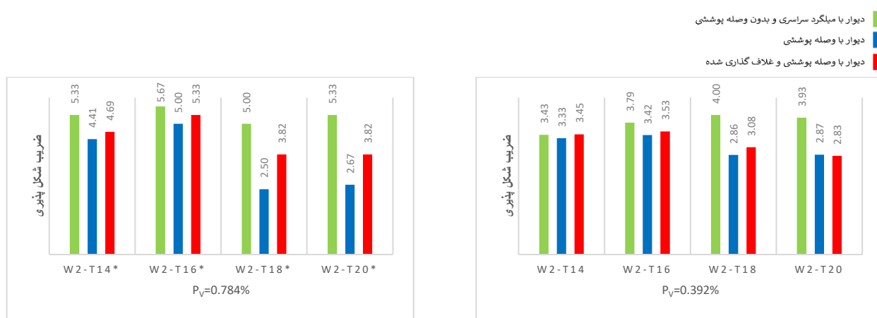
شکل (ب): ضریب شکل پذیری گروه دیوارهای با میلگرد برشی زیاد
