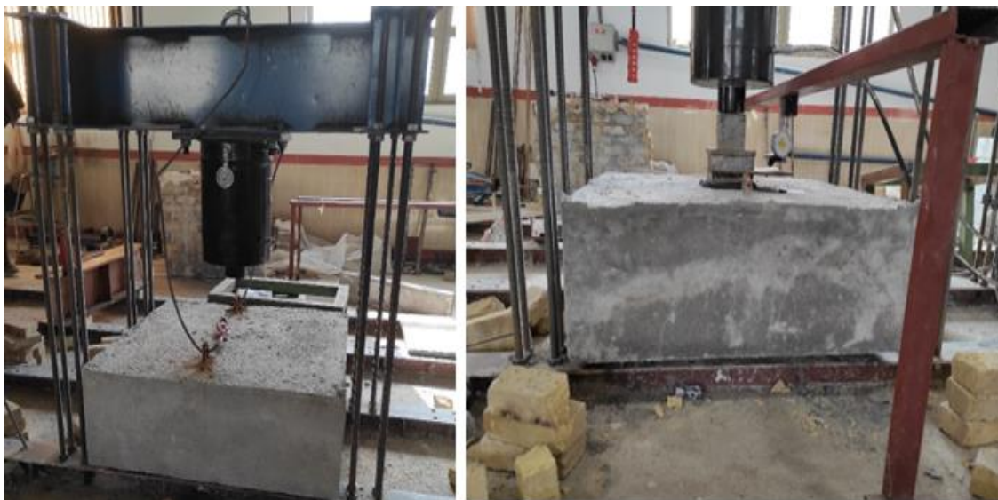
شکل ۸: استقرار نمونه سرشمع روی تکیه‌گاه، نصب صفحه بارگذاری و جابجایی سنج
