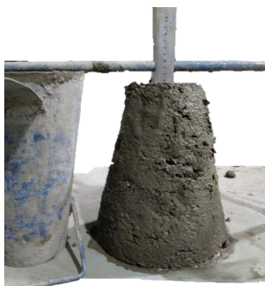
شکل ۹: اندازه گیری اسلامپ برای طرح R۶۶PT
