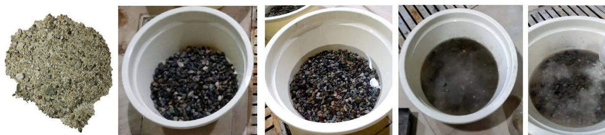
شکل ۴: نمایی از مخلوط حاوی سنگدانه بازیافتی و محلول اسیدی به ترتیب از راست به چپ: در حین افزودن اسید، چند لحظه پس از افزودن اسید، بعد از ۲ ساعت غوطه‌وری در اسید، پس از تخلیه اسید در پایان ۲۴ ساعت غوطه‌وری (شکل آخر بیانگر ملات و ریزدانه‌های جدا شده در پایان شستشو است)
