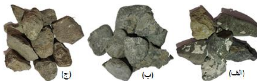
شکل ۱: انواع سنگدانه استفاده شده در این مقاله: (الف) سنگدانه بازیافتی اسیدشویی شده (ب) سنگدانه بازیافتی اسیدشویی نشده (ج) سنگدانه طبیعی
