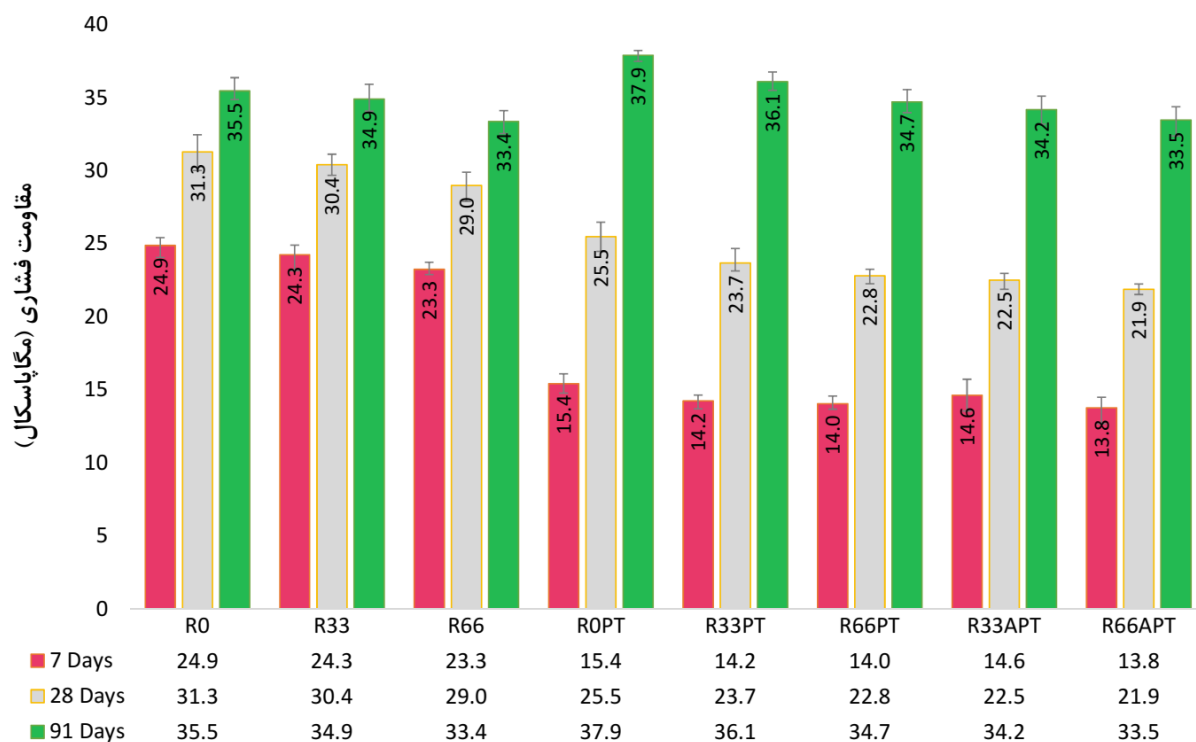
شکل ۶: مقاومت فشاری نمونه ها در سنین ۷، ۲۸ و ۹۱ روز
