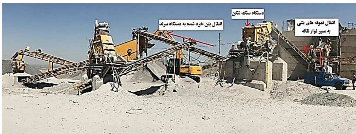
شکل ۱: مراحل تهیه و سرند شدن سنگدانه‌های بازیافتی
