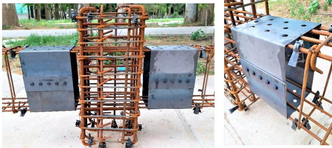
شکل ۳ محل و نحوه نصب ورق‌های فولادی در محدوده مفصل پلاستیک تیرهای بتنی نمونه شماره ۲
