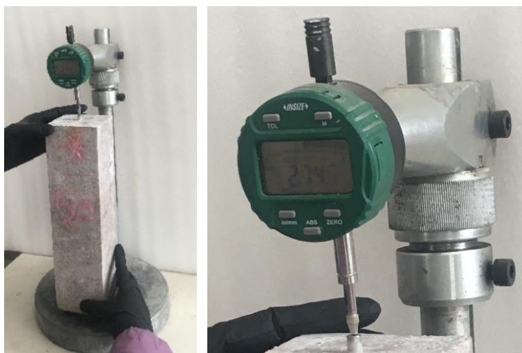
شکل ۴: نحوه‌ی اندازه‌گیری تغییرات طول نمونه
