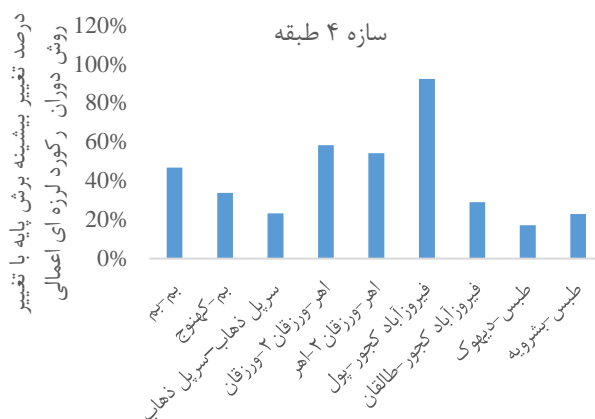
شکل ۱۰: بیشینه مقدار تغییر برش پایه ماکزیمم با تغییر روش دوران رکورد لرزه ای اعمال شده به سازه: الف) سازه ۴ طبقه، ب) سازه ۸ طبقه
