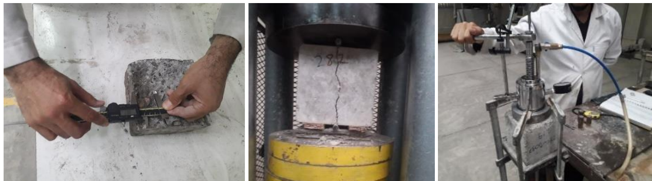
ج: اندازه گیری عمق نفوذ
