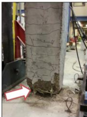
شکل الف) نوع شکست مفصلی ستون در آزمایشگاه
