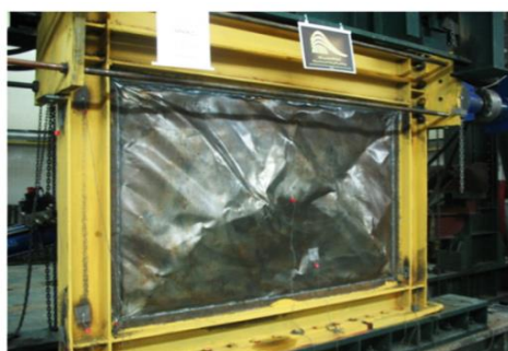
شکل ۵: تغییر شکل پلاستیک ستون نمونه SPSW2 در دریفت ۴/۵۶٪ [۱۷]
