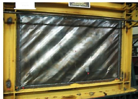
شکل ۳: تشکیل میدان کشش قطری نمونه SPSW2 در آزمایشگاه [۱۷]
