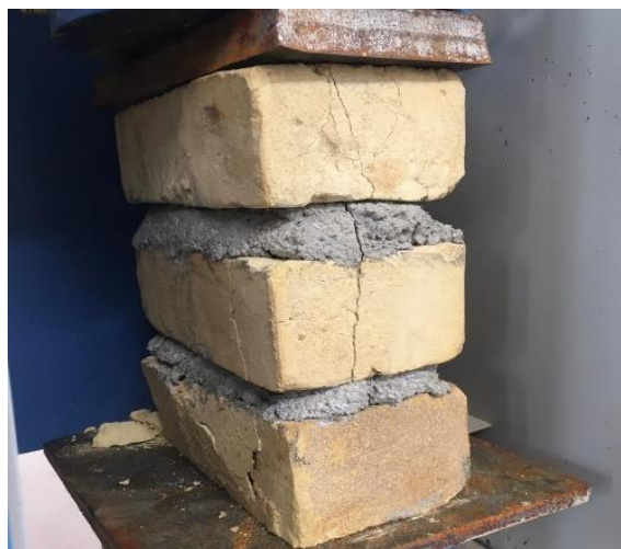
شکل ۶: آزمایش مقاومت فشاری واحد مصالح بنایی.
