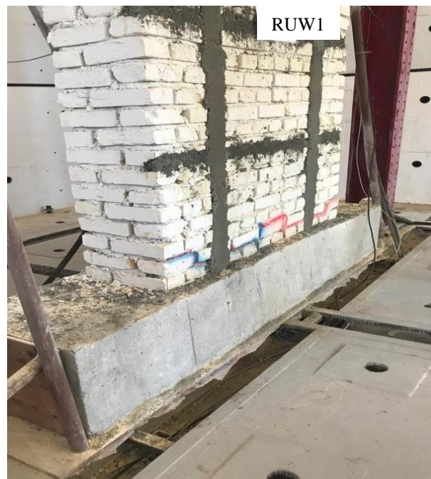
شکل ۱۳: در نسبت جابجایی 0/0917\% اولین ترکهای قابل دیدن.
