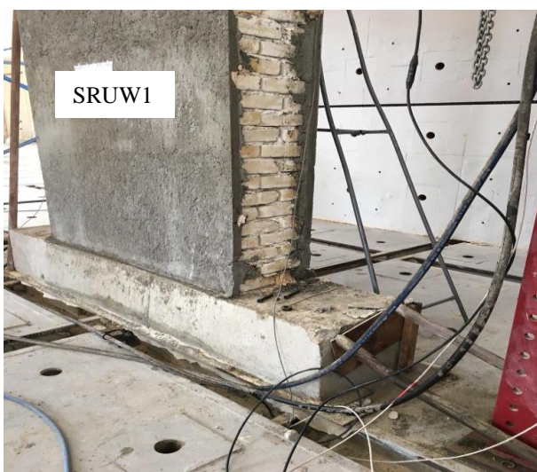
شکل ۱۸: ترک بعدی با ادامه دادن بارگذاری در سمت راست نمونه.
