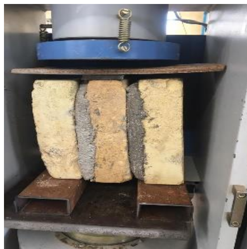
شکل ۵: آزمایش مقاومت برشی محل اتصال.
