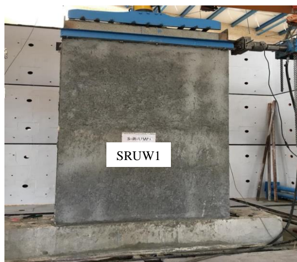
شکل ۱۷: در نسبت جابجایی ۰/۲۵٪ اولین ترک‌های قابل دیدن.
