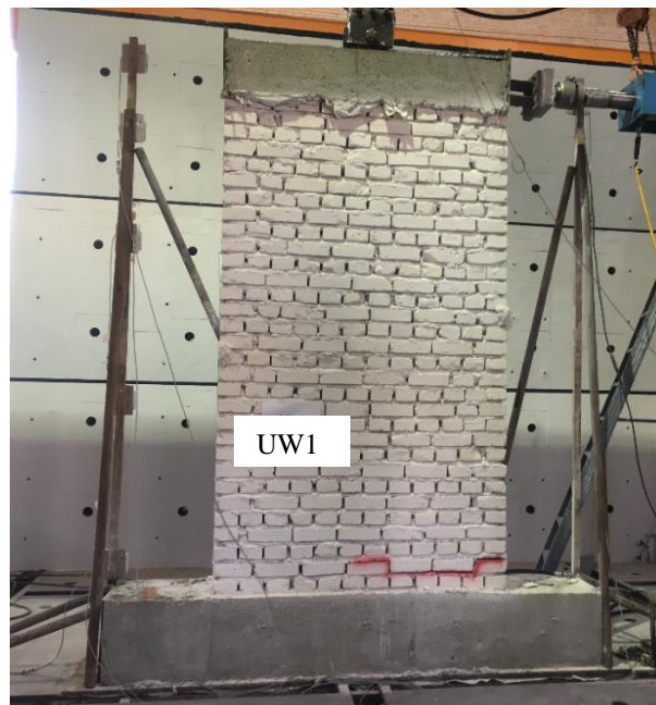
شکل ۱۰: در نسبت جابجایی 0/107\% وقوع ترک‌های اولیه.
