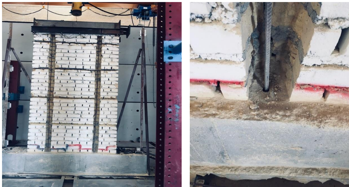
شکل ۲: نحوه کاشت میلگرد در نمونه RUW1.
