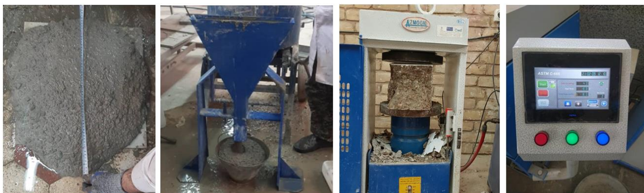
شکل ۴ برنامه آزمایشگاهی تحقیق (از سمت چپ به راست به ترتیب: اندازه قطر جریان اسلامپ، آزمایش قیف V، مقاومت فشاری، نمایشگر دستگاه فریزر بتن)
