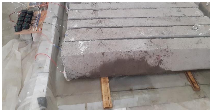
شکل ۵: تیرهای بتنی پیش کشیده تحت عمل خوردگی تسریع شده شکل ۶: منبع تغذیه ساخته شده جهت اعمال جریان ثابت
