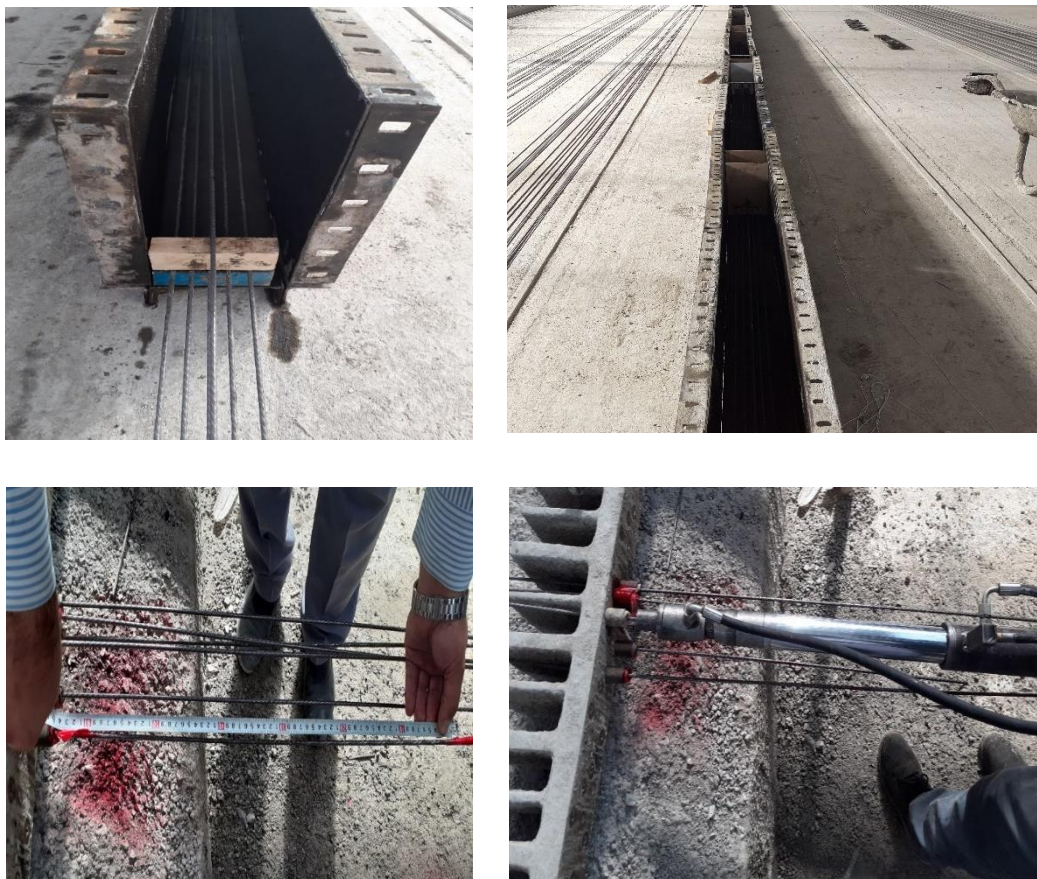
شکل ۳: قالب‌بندی، جانمایی و کشیدن وایرها به وسیله جک هیدرولیکی برقی
