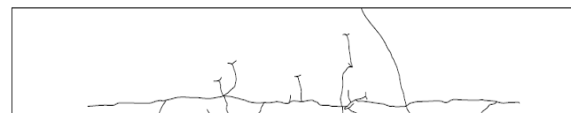
شکل ۲۱: مود شکست و الگوی ترک تیرها
