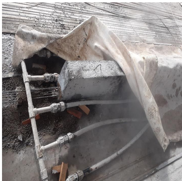
شکل ۴: خط تولید طولی و عمل آوری تیرهای پیش کشیده با روش لحاف بخار آب
