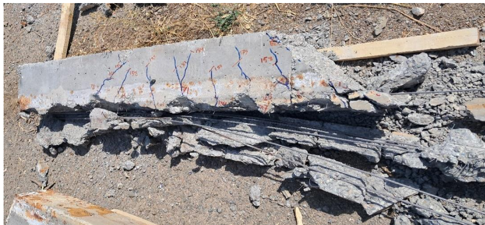
شکل ۱۰: تخریب بتن نمونه‌ها بعد از آزمایش با چکش برقی تخریب بتن (هیلتی) و بیرون کشیدن فولادهای پیش تنیدگی
