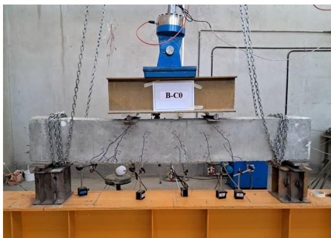
شکل ۹: آزمایش خمش چهار نقطه‌ای
