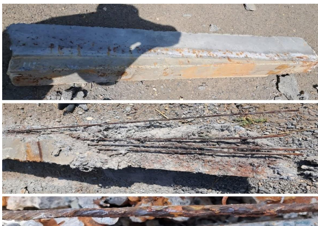
شکل ۱۱: محصولات خوردگی ایجاد شده روی فولادهای پیش تنیدگی و سطوح زیرین و جانبی تیرهای پیش تنیده
